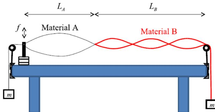
Figura 7.3: Esquema para montagem do experimento com a corda segmentada.
