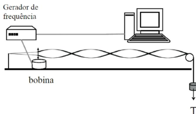
Figura 7.1: Esquema de montagem para o experimento da corda vibrante.
