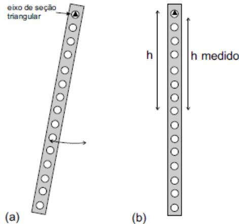
Figura 2.2: (a) Oscilação de uma barra perfurada em torno de um eixo de seção triangular. (b)  $h$  é medida que corretamente corresponde à distância entre eixo de oscilação e o centro de massa. A medida realizada,  $h_{medido}$ , é sistematicamente menor do que  $h$ .
