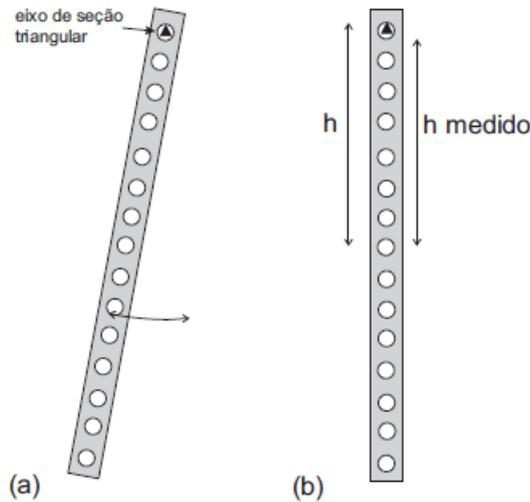
Figura 10.2: (a) Oscilação de uma barra perfurada em torno de um eixo de seção triangular. (b)  $h$  é a medida que corretamente à distância entre eixo de oscilação e centro de massa. A medida realizada corresponde,  $h_{medido}$  é sistematicamente menor do que  $h$ .
