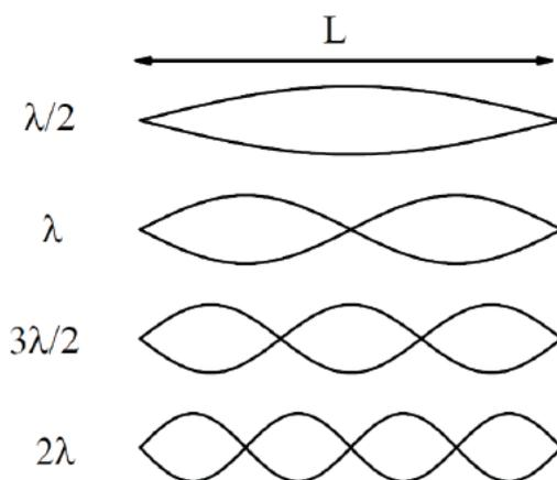
Figura 7.2: Diferentes modos de vibração esperados para  $n=1,2,3$  e  $4$ .
